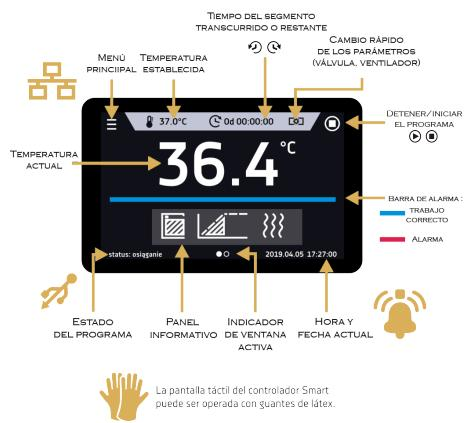
La pantalla táctil del controlador Smart puede ser operada con guantes de látex.
