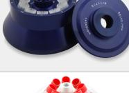
Angular 10 x 10 ml. / Max: 14000 Rpm. / FCR Max: 15558 xg / 30°. Hermético y sellado.               |
