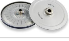
24 capilares de 50mm./ Max: 14500 Rpm. / FCR Max: 14574 xg horizontal / Hermético y sellado.           |
