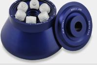
Angular 6 x 30 mL. / Max: 15000 Rpm. / FCR Max: 19621 xg / 30°. Hermético y sellado. Tubos tipo Nalgene.   |
