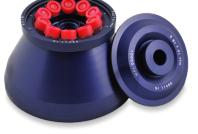
Angular 10 x 15 mL. / Max: 10000 Rpm. / FCR Max: 10732 xg / 30°. Hermético y sellado. Tubos Falcon.        |
