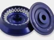
Angular 24 x 1.5/2.2 mL. / Max: 15100 Rpm. / FCR Max: 21158 xg 45°. Hermético y sellado.             |
