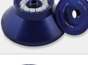
Angular 12 x 5 mL / Max: 14000 Rpm. / FCR Max: 19064 xg / 45°. Hermético y sellado.                |
