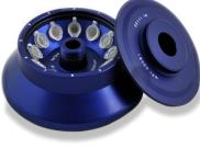
Angular 12 x 1.5/2.2 mL / Max: 18000 Rpm. / FCR Max: 24270 xg 45°. Hermético y sellado.              |
