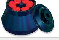
Angular 6 x 50 mL. / Max: 10000 Rpm. / FCR Max: 10732 xg / 30°. Hermético y sellado. Tubos Falcon.        |
