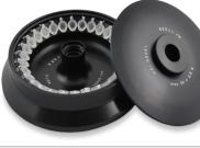
Angular 30 x 1.5/2.2 mL / Max: 15000 Rpm. / FCR Max: 24400 xg 45°. Hermético y sellado.           |
