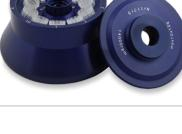
Angular 10 x 10 mL / Max: 14000 Rpm. / FCR Max: 15339 xg / 30°. Hermético y sellado.               |
