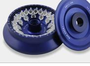
Angular 36 x 1.5/2.2 mL / Max: 18000 Rpm. / FCR Max: 30065 xg 45°. Hermético y sellado.           |
