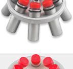
Angular 8 x 50 mL. / Max: 5000 Rpm. / FCR Max: 4227 xg / 30°.<br>Seguridad Biológica. |
