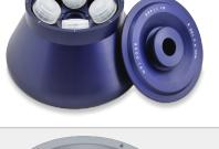
Angular 4 x 85 mL. / Max: 10000 Rpm. / FCR Max: 10621 xg / 30°. Hermético y sellado. Tubos tipo Nalgene. |
