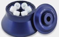
Angular 6 x 50 mL./ Max: 12000 Rpm./ FCR Max: 14490 xg / 30°. Hermético y sellado. Tubos tipo Nalgene. |
